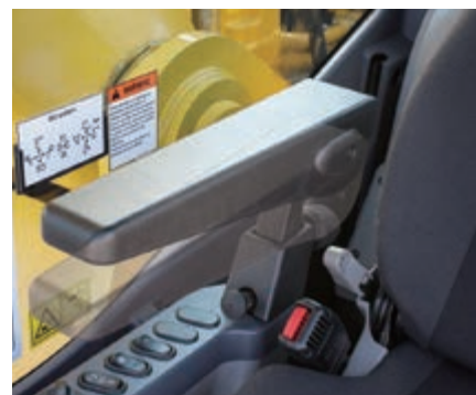
Loketní opěra s jednoduchým seřízením výšky
