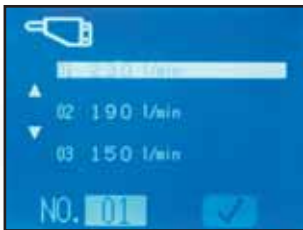
Hydraulický průtok, v hlavní nabídce nastaven režim B (Breaker)
