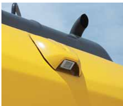
Zadní kamera nepřesahující obrys stroje
