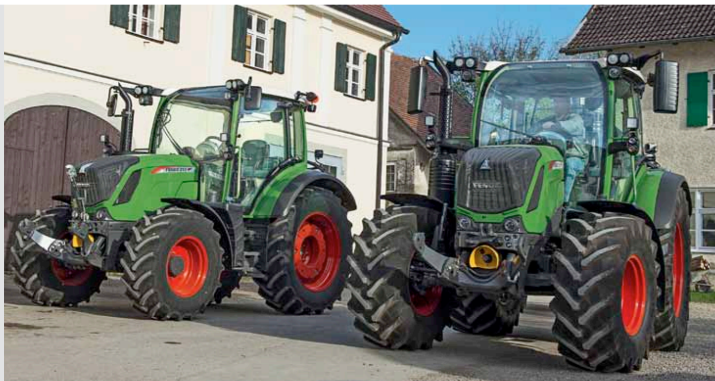
Spolehlivé duo: Fendt 300 Vario vám nabízí ve verzi Power, ale také ve verzi Profi, nejlepší řešení pro vaše individuální požadavky a všestrannost připojení vpředu: horní táhlo, dvojčinný ventil a beztlakovou zpátečku, 7-pólovou zástrčku, přední vývodový hřídel (1000 ot/min), EHR komfortní přední ramena (Profi), háky spodních ramen, sklápěcí spodní táhlo, uzavírací kohout;
